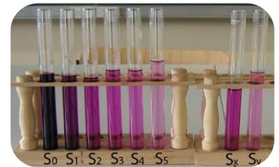
Doser une solution colorée par étalonnage consiste à déterminer la concentration de cette solution soit en comparant sa couleur avec les couleurs de celles de l'échelle de teintes à l'œil nu, soit en comparant l'absorbance des solutions à l'aide d'un spectrophotomètre.
