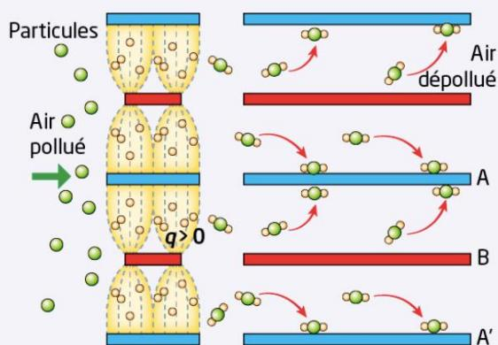
Dans un premier temps, l'air entrant traverse une zone d'ionisation dans laquelle les particules se chargent positivement.
