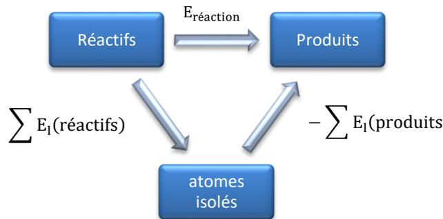
$$E_{\text{réaction}} = \sum E_l(\text{réactifs}) - \sum E_l(\text{produits})$$
