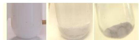
Précipité blanc \text{AgCl}_{(s)} Le précipité se dépose et noircit à la lumière
