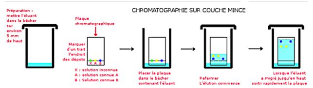
Au cours de l'élution, l'éluant monte le long de la surface de la plaque. On dit qu'il migre. Il entraîne avec lui les différents constituants du mélange à des vitesses différentes.
