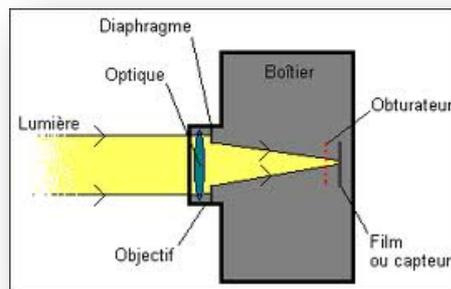
**Rq :** Pour parvenir à des images de haute qualité, l'optique (système de lentilles) utilisée peut être complexe. Mais malgré cela, le principe de fonctionnement reste le même.
